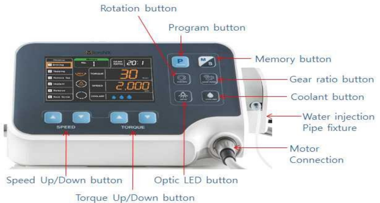
Рисунок 3. Консоль управления вид спереди
